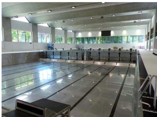
50-Meter-Becken mit den zwei fahrbaren Trennelementen für den 25-Meter-Betrieb.
