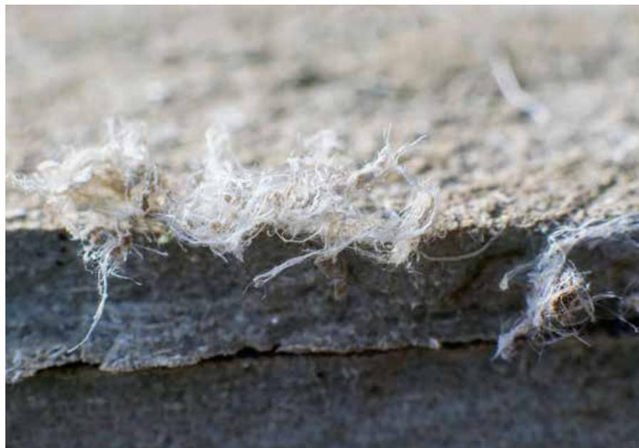
Bild oben: Detailfotografie von Baumaterial mit Asbestfasern.
