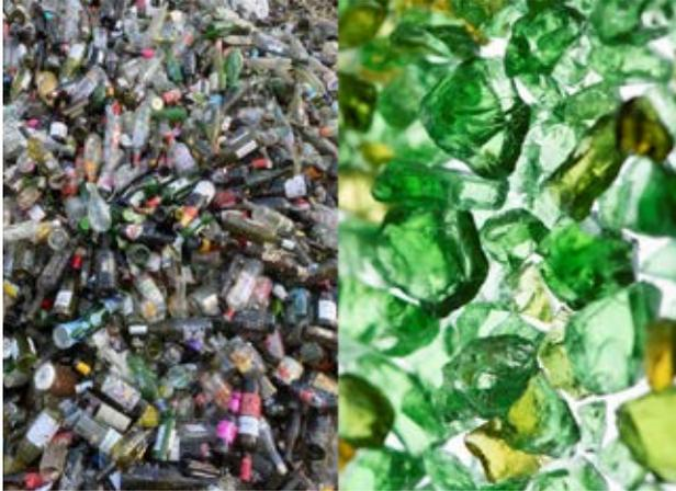
Aus recycelten Glasflaschen wird das Filtermaterial AFM® hergestellt.
